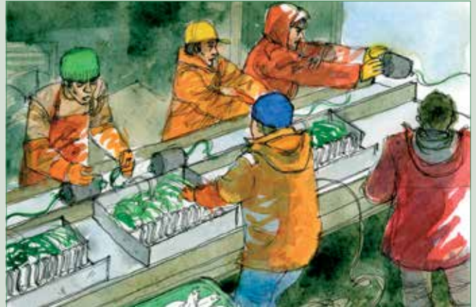
그림 2. 무게추를 투승작업대에서 밀어내고, 낙시는 금속으로된 받치를 사용하여 던지면 장력을 감소시켜 침하율을 증가시킬 수 있다.
